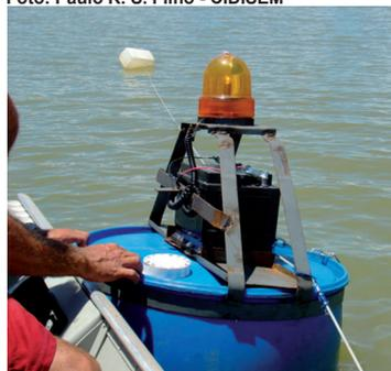
Sinalizador tipo giroscópio
