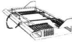
Draga para bivalves tipo industrial Peso (vazio): 500-1 000 kg
