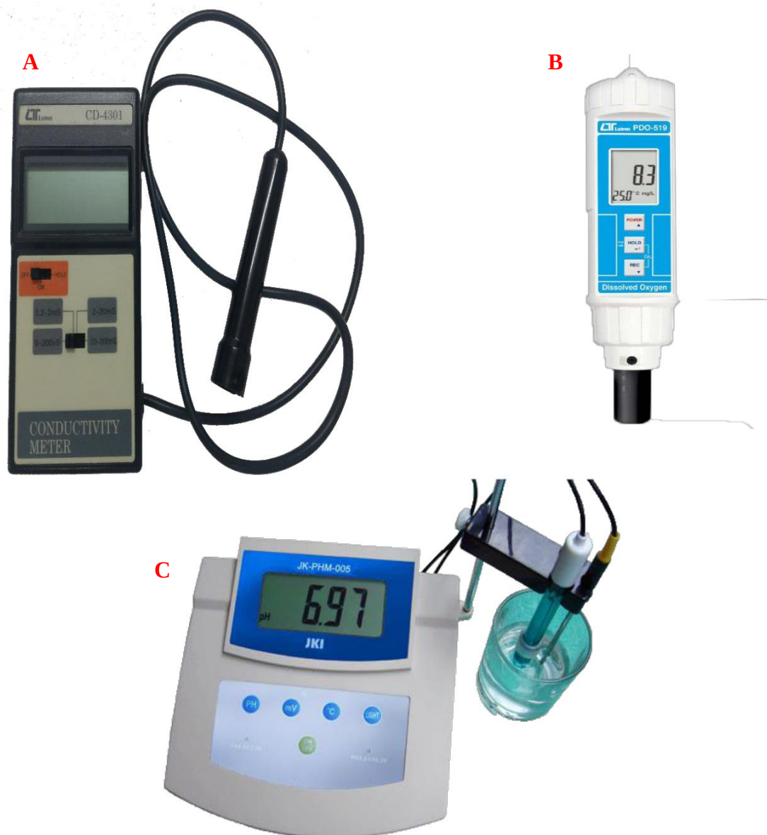
Figura 2 – Equipamentos utilizados para realizar a análise dos parâmetros físico-químicos da Microbacia do Rio Praiquara, Castanhal, Amazônia Oriental. (A) condutivímetro, (b) Equipamento para medição do oxigênio dissolvido e (c) pHmetro.
