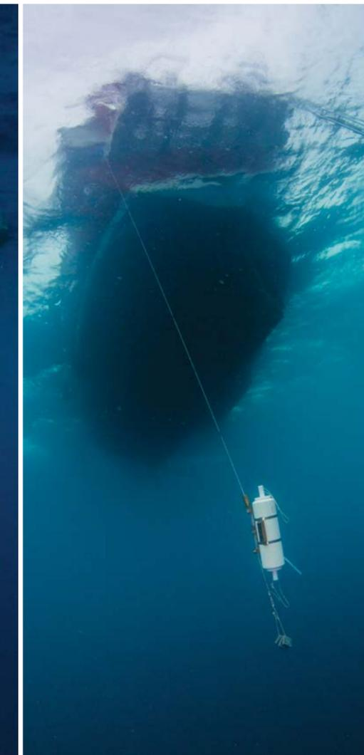
Garrafa fechada, com amostra de água do mar sendo recolhida para a embarcação.
