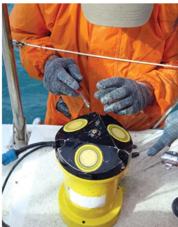
Perfilador de correntes (ADCP) a bordo da embarcação durante a etapa de manutenção e descarregamento de dados.
