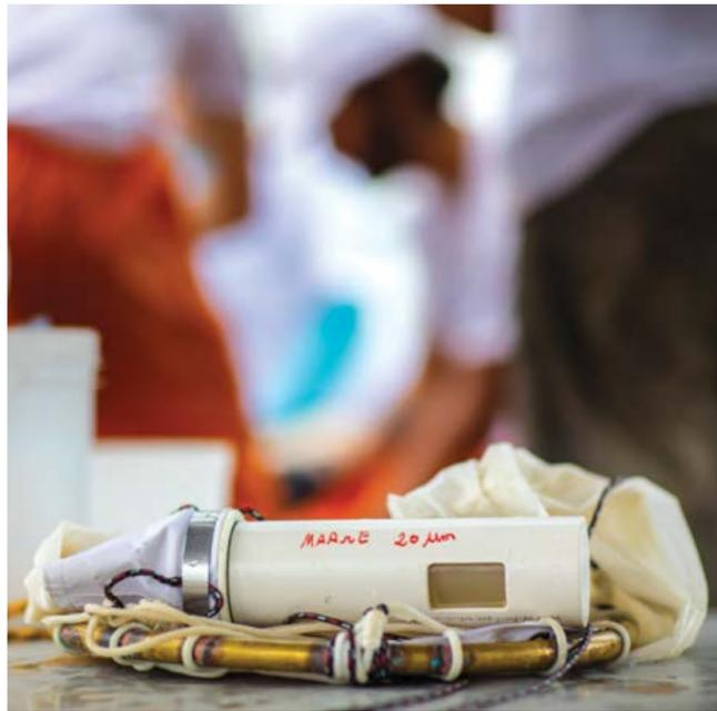
A amostragem do microplâncton é realizada usando uma rede com uma malha de apenas 20 µm (0,02 mm).
