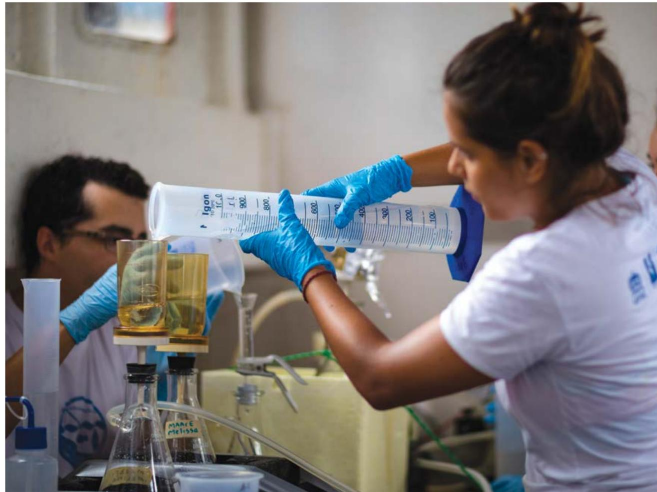
A filtração da água do mar para análise de nutrientes, clorofila e material em suspensão envolve o uso de equipamentos frágeis e de muita precisão, além de grande atenção dos pesquisadores.
