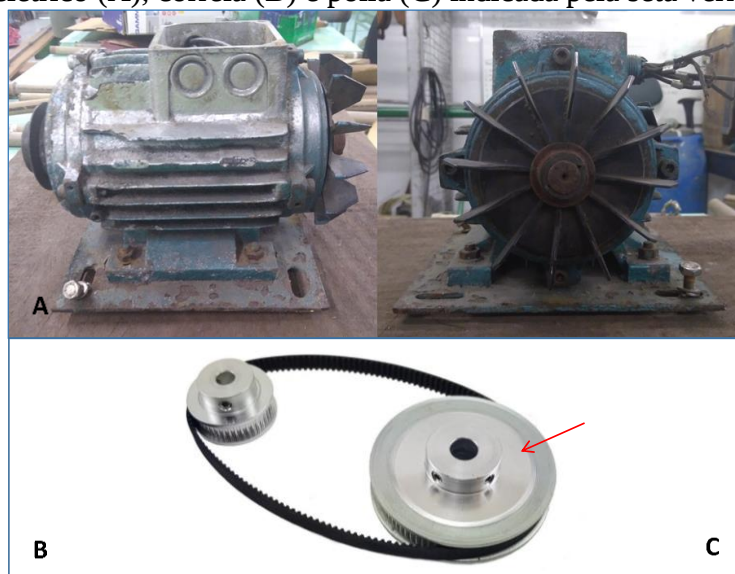
Figura 4 - Motor elétrico (A), correia (B) e polia (C) indicada pela seta vermelha
