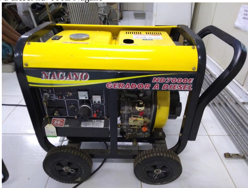
Figura 7 - Gerador a diesel nd7000E Nagano
